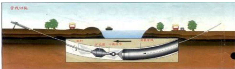
图 4-5 定向钻管线回拖施工示意图
